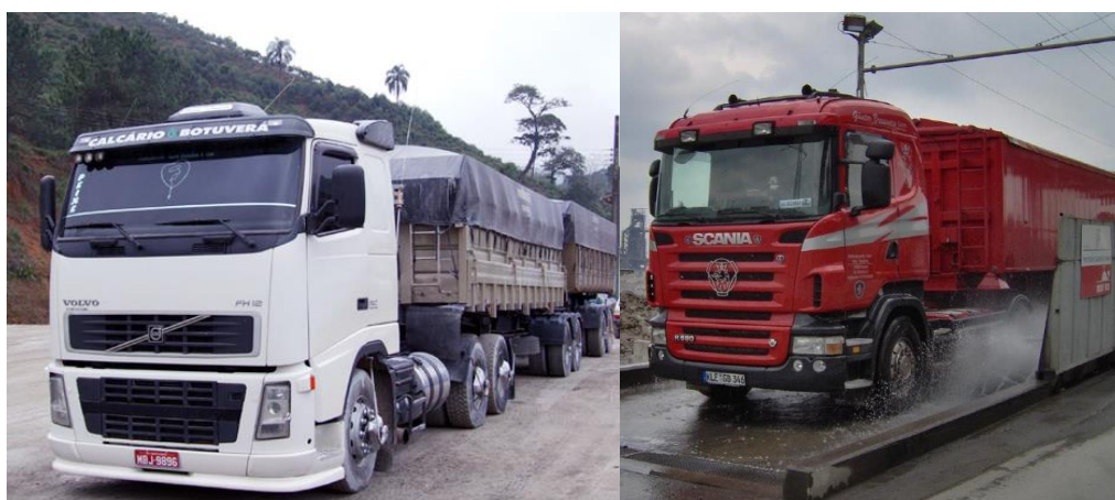
Figura 13 - Exemplos de transporte com cobertura e lavagem de rodados, retirados de (Mascus 2015; Transprimo 2015)
